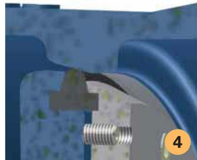
Endlose Dichtung im Abschluss aus belastbarem Elastomer in speziellem T-Profil über einteiligem Klemmring auf der Klappenscheibe befestigt. Exakte Vorspannung und Sicherung über Befestigungsschrauben und Konterstifte gewährleisten gesicherte Funktionsdichtheit.
